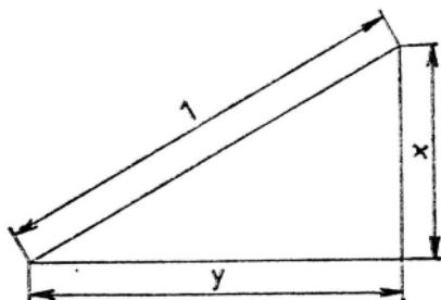
V pravoúhlém trojúhelníku o přeponě délky 1 platí vztah  $y = \sqrt{1-x^2}$ , nebo  $x = \sqrt{1-y^2}$ . Na základě uvedeného vztahu použijeme stupnice  $\sqrt{1-x^2}$  k různým výpočtům:
