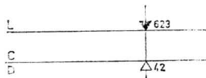
Index okénka přesuneme na hodnotu 42 na stupnici D a pod tímto indexem čteme na stupnici L mantisu 623.
