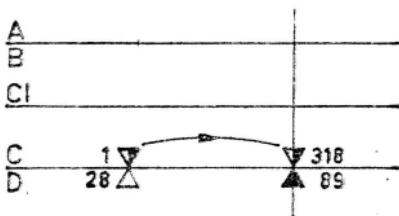
Násobení provádíme pro přesnější určení hodnot na stupnici základní C a D. Počátek stupnice 1 šoupátka nastavíme na 28 stupnice D pravítka. Index okénka zastavíme na hodnotu násobitele 3,18 a pod indexem na stupnici D čteme součin 89.
