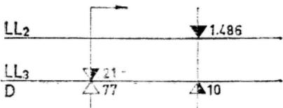
Nad daný exponent 7,7 na stupnici D nastavíme číslo 21 stupnice LL<sub>3</sub>. Přesuneme index okénka na 10 stupnice D a čteme pod indexem výsledek 1,486 na stupnici LL<sub>2</sub>. (Podle pravidla v odstavci 13b, neboť bylo použito hodnoty 10 na stupnici D.)
